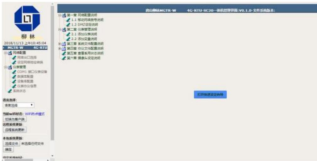
4. 通过查看连接状态确认是否连接成功：点击 系统配置 → 系统状态，状态下显示绿色闪烁状态，即通讯成功。
